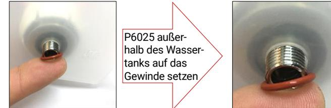
5. Schrauben Sie nun den Wassertankstutzen auf das Gewinde. Achten Sie darauf, dass die Kugel unten im Stutzen sitzt und darauf die Feder folgt. Halten Sie innen das Gewinde mit einem Inbusschlüssel. Fetten Sie anschließend den Wassertankstutzen (wenn vorhanden) mit Lebensmittel-geeigneten Silikon-Fett ein.
